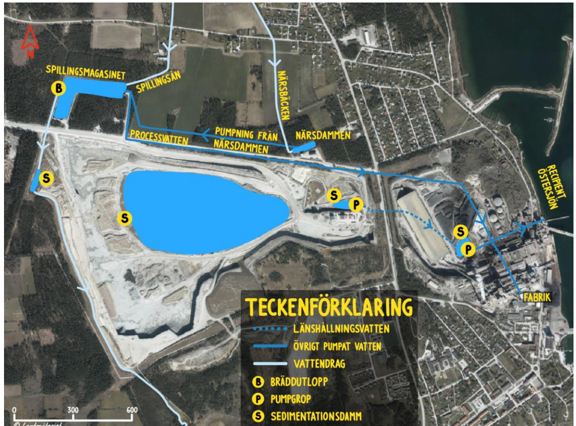
Figur 6. Schematisk bild över vattenhanteringen vid Västra brottet. På bilden benämns Spillingsmagasinet Spillingsdammen.
