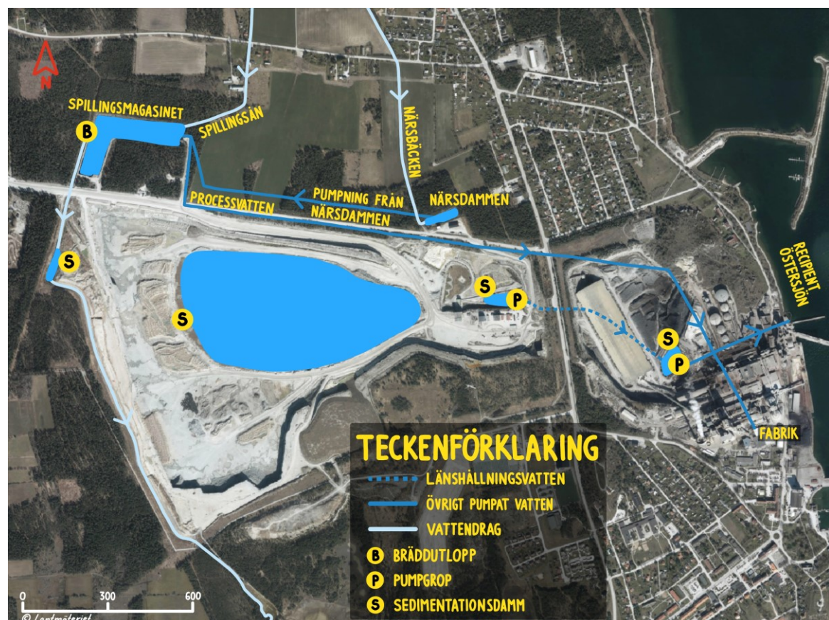
Figur 8.2. Schematisk bild över vattenhanteringen vid Västra brottet.
