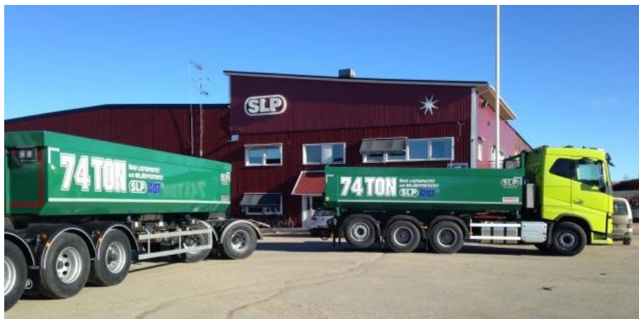
Figur 27: Sidotippande 74-tonns ekipage med kort, fem-axlat släp (Källa: SLP)
