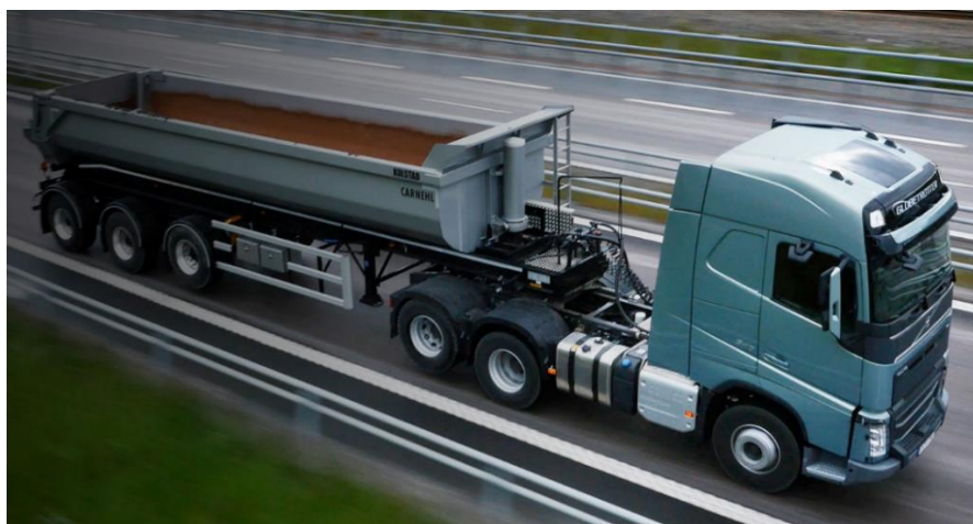
Figur 29: Volvo FH med tandemaxellyft och med tipptrailer (källa: Volvo AB)
