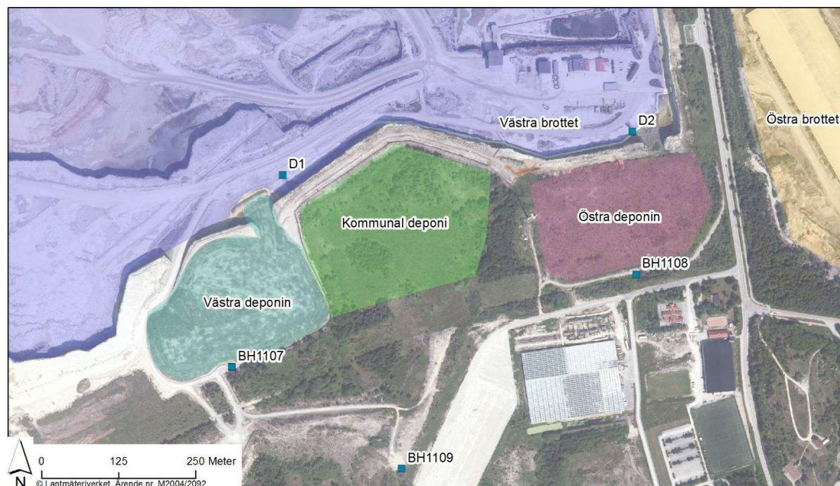
Figur 11: Provtagningspunkter för lakvatten, D1 och D2, samt kontrollbrunnar för grundvatten BH1107, BH1108 och BH1109.
