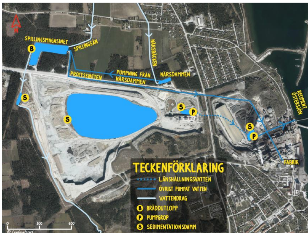
Figur 2. Schematisk bild över vattenhanteringen vid Västra brottet.
