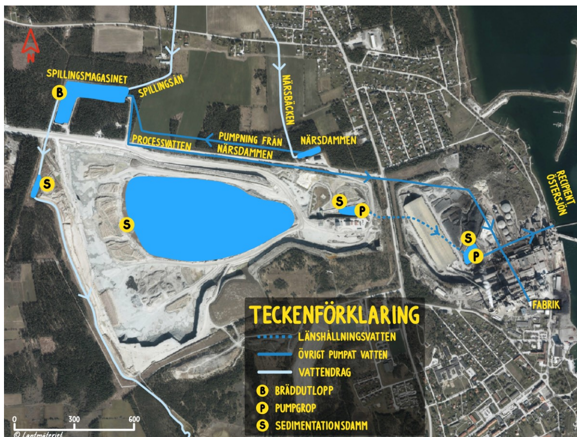
Figur 5.3. Schematisk bild av nuvarande vattenhantering vid Västra brottet.
