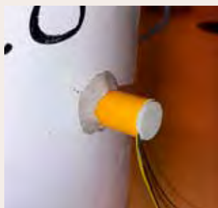
1. Borrhålmätning med tätning mot plåt.
