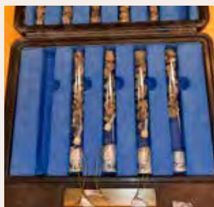
3. HG-givare i provrör med krossad betong. Provrören placeras i en väska med isolering.
