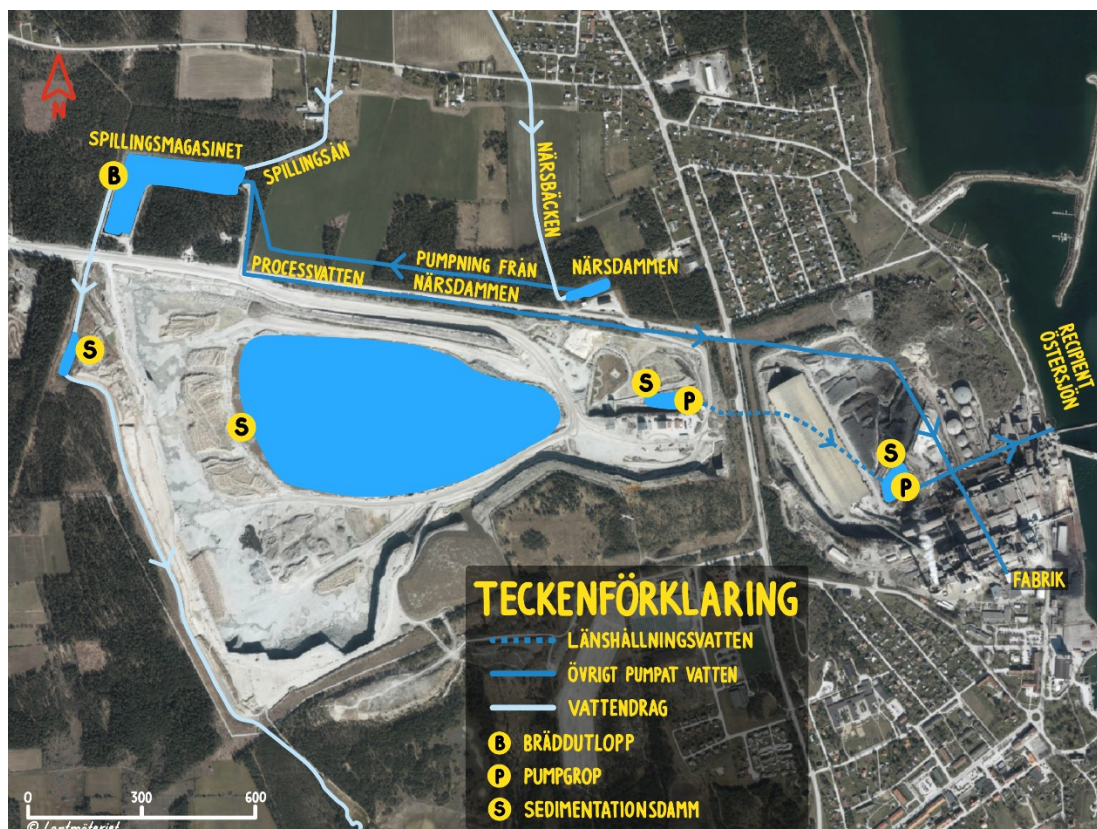
Figur 20. Schematisk bild över vattenhanteringen vid Västra brottet.
