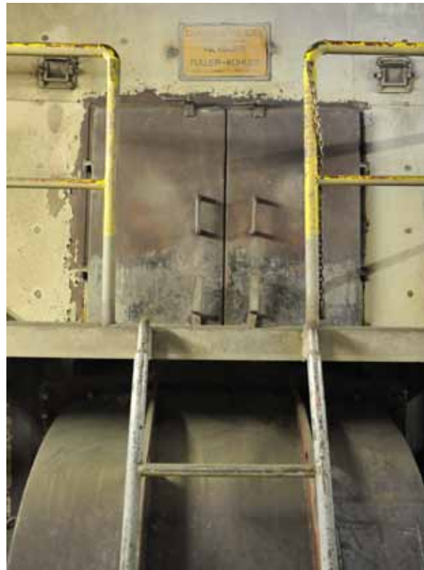
Till vänster syns planetkylaren på ugn 4 och till höger delar av den rostkylare av modell Fuller som verkar i ugnslinje 3. Foto SOA 2010
