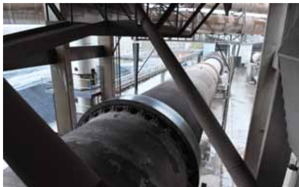
Ovan syns brännarplan vid ugn 4 med reglerutrustning för bränslet och till höger den transportör som för ned klinkern till lagret. Nedersta bilden visar ett vattenkyllt bärlager för ugn 3. Däremellan ändrvy från inmatningszonen vid ugn 4. Foto SOA 2010
