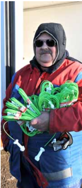
Överst: Gruvan är vidsträckt och omfattar flera kvadratkilometer. Sprängarbasen Paul Johansson med famnen full av elektriska detonatorer – som kopplas samman till ett noga uträknat nät där laddningen i varje borrhål kommer att detonera med en anings tidsförskjutning. Allt för att salvan ska släppa på ett kontrollerat sätt. Bild SOA 2010
