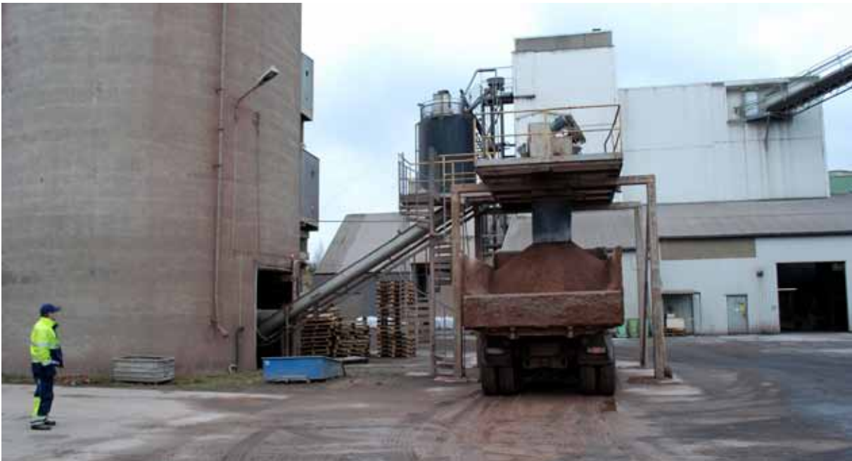
I denna silo lagras stoft från cementugnarnas elfilter – CKD (Cement Kiln Dust). En del av detta stoft kan inte återvinnas utan läggs på deponi i närheten av kalkstensbrottet. På bilden väntar Teddy Gustavsson medan flaket på hans lastbil fylls med CKD. Foto LKU 2010
