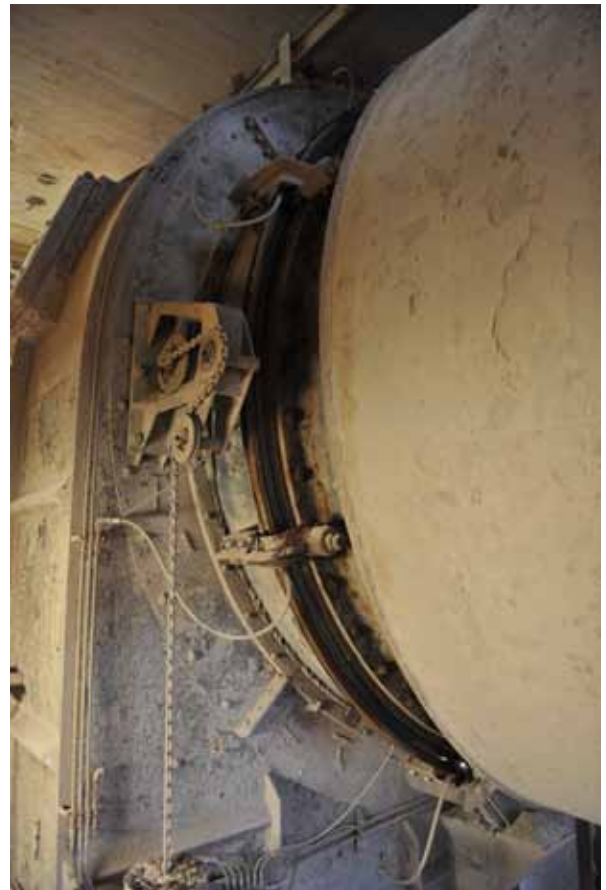
Ovan syns inmatningszonerna till ugn 3 och 4. Olika tekniska lösningar borgar för att råmjölet stannar i ugnen och att det inte läcker in tjuvluft som kan störa förbränningen. Nedan syns drivpunkten och en av löpringarna på ugn 4. Bilder SOA 2010
