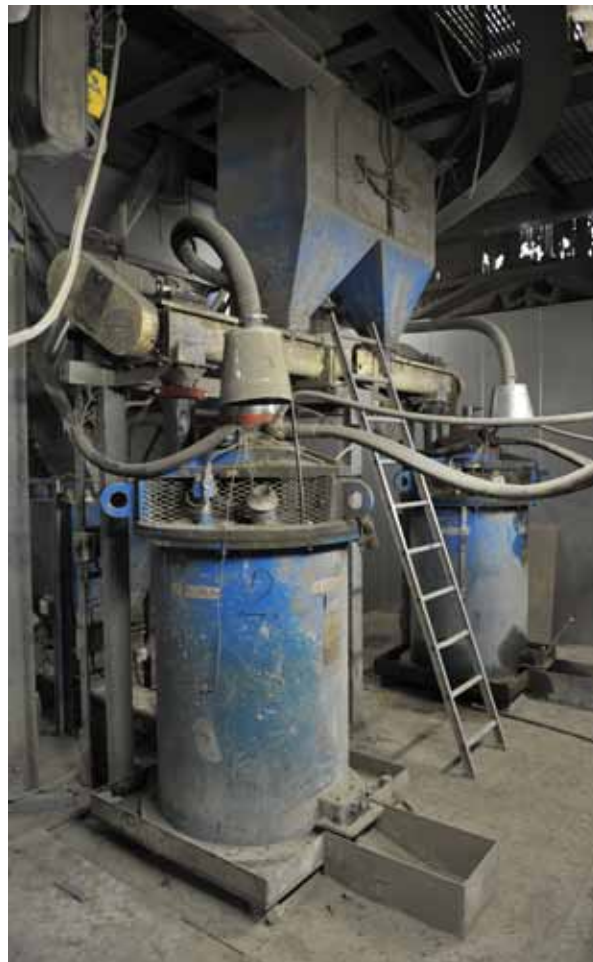
Två av kvarnarna som används till microcementmalningen. Kvarnarna drivs av hydraulmotorer. Foto SOA 2010
