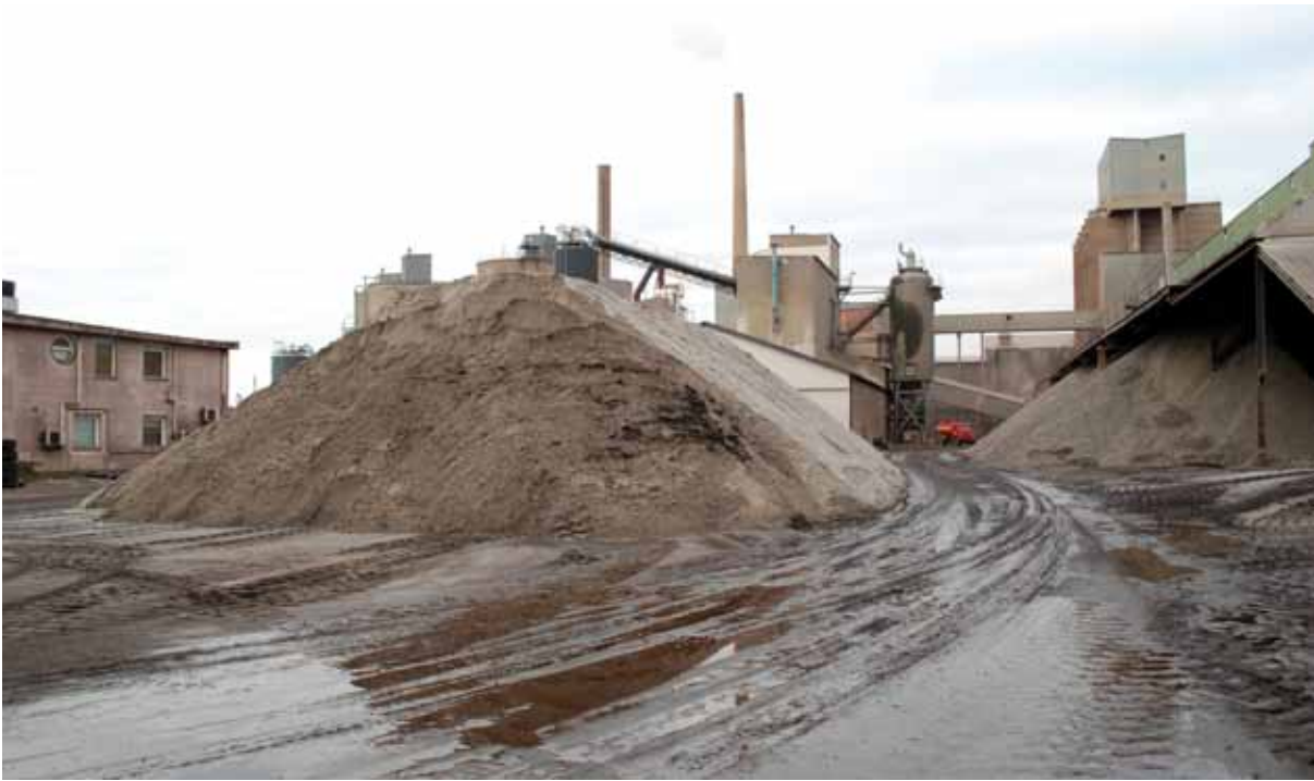
För att justera cementets kiselinnehåll tillsätts sand som lagras på fabriksområdet under bar himmel. Sanden kommer från Bornholm. Till höger i bild skymtar stenlagret. Foto LKU 2010
