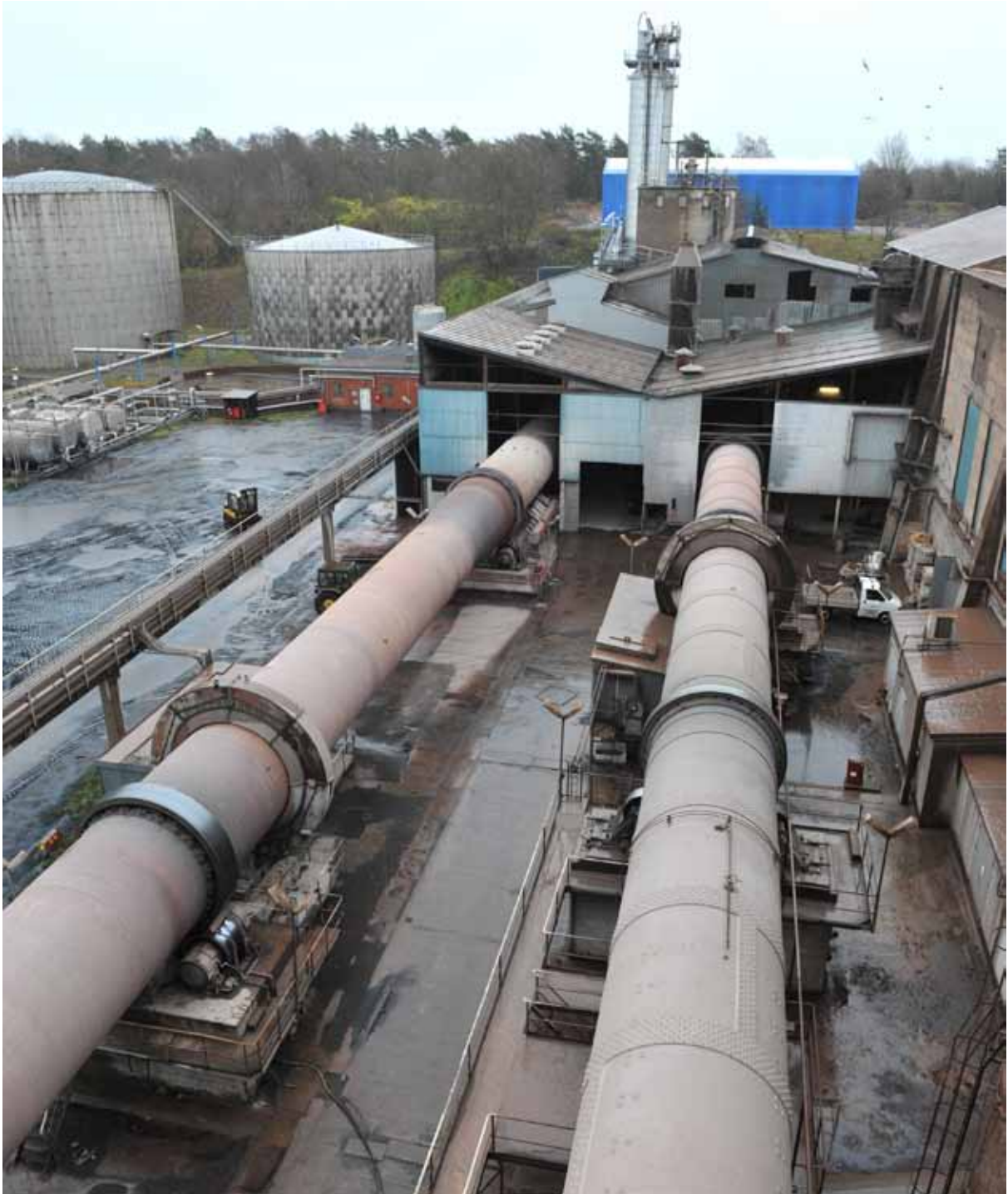
Ugn 3 till höger från 1952 och den tio år yngre ugn 4 till vänster. Notera skillnaden i ugnsmanteln's sammanfogning. Ugn 3 nitad – ugn 4 svetsad. Ett enkelt plåtskydd hindrar regn och snö att ta sig in till ugnarnas brännarplan. Foto SOA 2010
