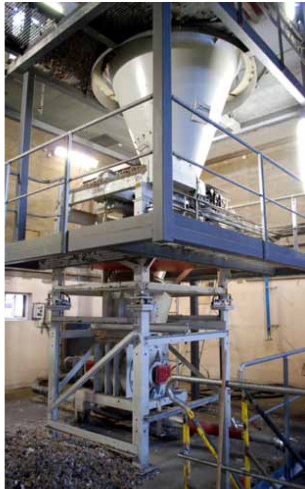
Sedan 2010 används plastbränsle vid cementfabriken i Degerhamn och i denna nyuppförda bränslehall lagras plasten i väntan på förbränning. Plastbränslet anländer till Degerhamn med lastbil. Foto LKU 2010
