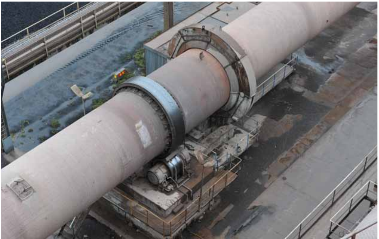
Ovan syns inmatningszonerna till ugn 3 och 4. Olika tekniska lösningar borgar för att råmjölet stannar i ugnen och att det inte läcker in tjuvluft som kan störa förbränningen. Nedan syns drivpunkten och en av löpringarna på ugn 4. Bilder SOA 2010
