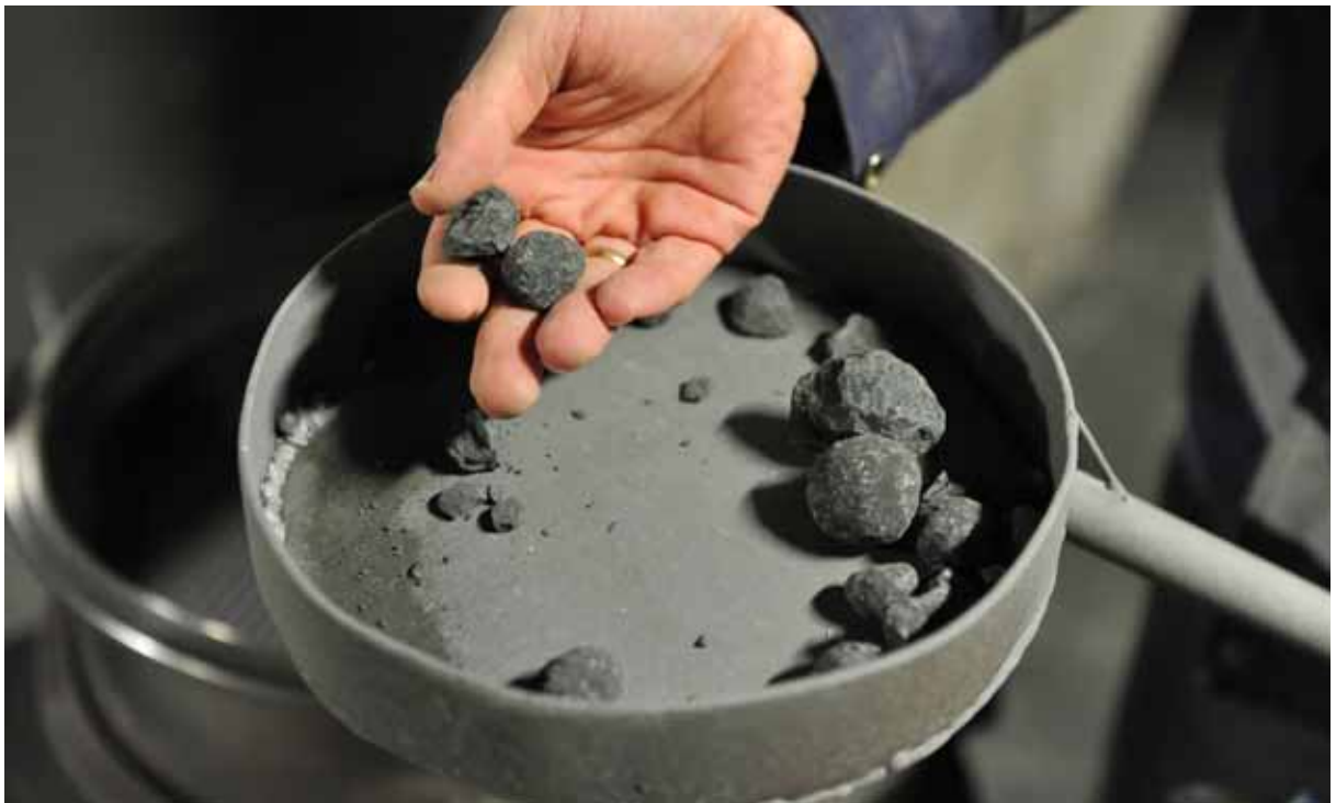
Cementklinkerprov taget ur ugn 4 där klinkern lämnar planetkylaren. Notera den naturliga storleksvariationen på klinkern. Bild SOA 2010.
