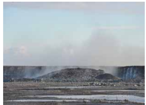
Detonationen talar för sig själv. Omkring 10 000 ton kalksten har sprängts loss och kan nu transporteras till krossen. Foto SOA 2010
