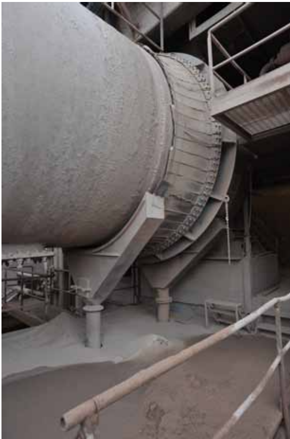
Ovan syns inmatningszonerna till ugn 3 och 4. Olika tekniska lösningar borgar för att råmjölet stannar i ugnen och att det inte läcker in tjuvluft som kan störa förbränningen. Nedan syns drivpunkten och en av löpringarna på ugn 4. Bilder SOA 2010
