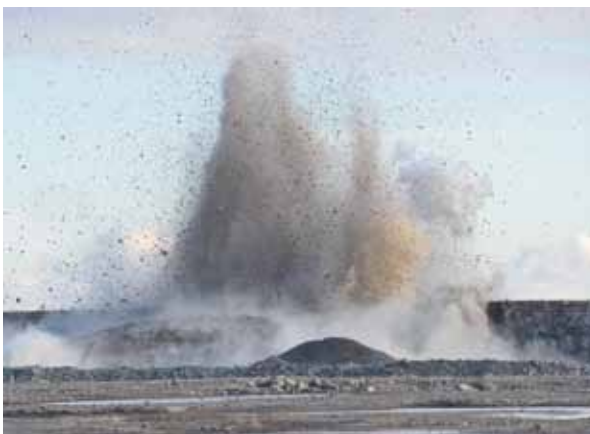
Detonationen talar för sig själv. Omkring 10 000 ton kalksten har sprängts loss och kan nu transporteras till krossen. Foto SOA 2010
