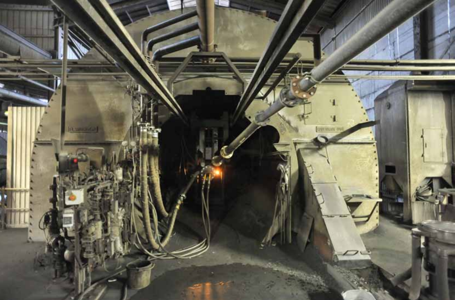
Ovan syns brännarplan vid ugn 4 med reglerutrustning för bränslet och till höger den transportör som för ned klinkern till lagret. Nedersta bilden visar ett vattenkyllt bärlager för ugn 3. Däremellan ändrvy från inmatningszonen vid ugn 4. Foto SOA 2010
