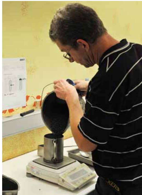
Volymvikten på klinkern mäts i driftlaboratoriet av processoperatör Tomas Eriksson. Bild SOA 2010
