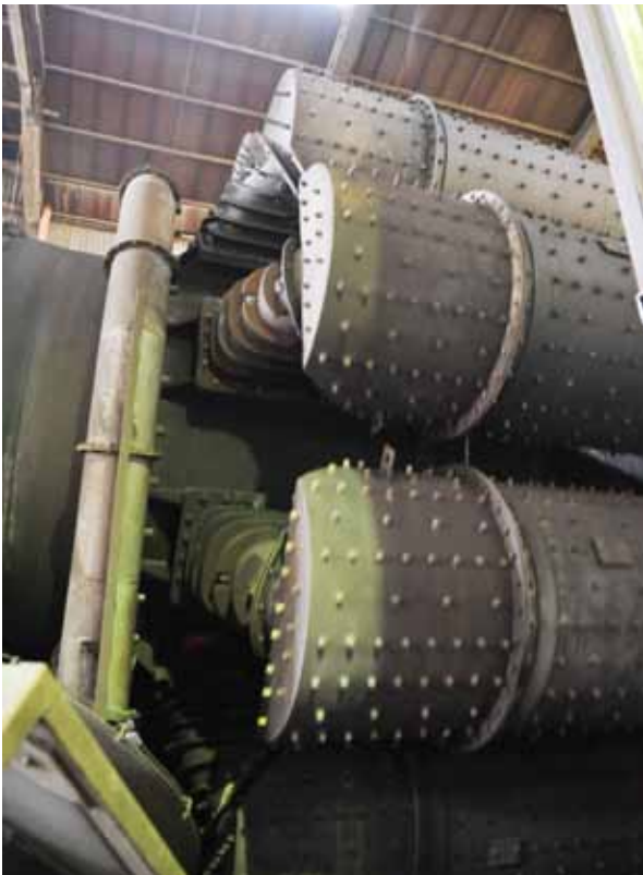
Till vänster syns planetkylaren på ugn 4 och till höger delar av den rostkylare av modell Fuller som verkar i ugnslinje 3. Foto SOA 2010
