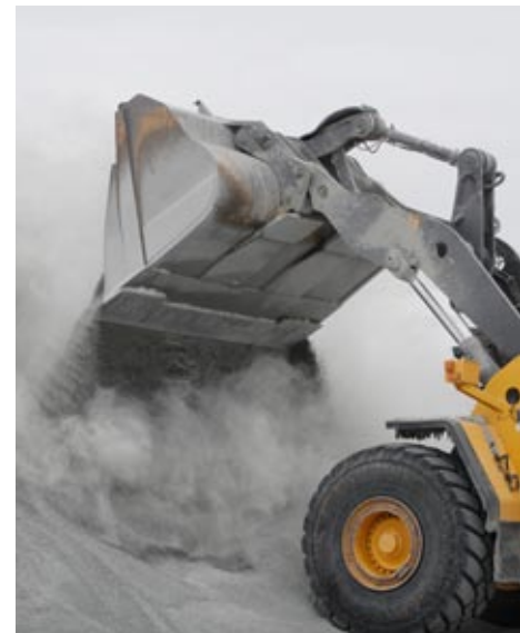
Krossning alstrar stora mängder damm och partiklar i luften som kan vara hälsofarlig att vistas i utan skydd.
