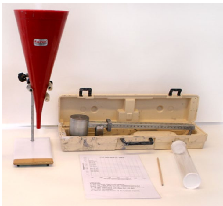
Figur 2 Exempel på utrustning för provning av injekteringsmaterial i fält. Mud balance för mätning av densitet och flödeskon för mätning av flödestid. Flytgräns kan mätas med en så kallad "yield stick". Inför injekteringsdesign utförs mätningar i laboratorium för att ta fram designparametrar. Värderna från mätningarna i fält används för kontroll av egenskaper inför injektering (foto Nina Zanders).
